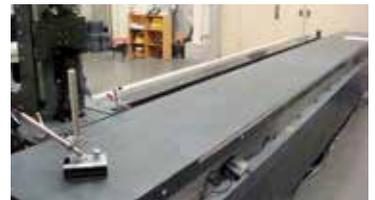
5m真直度測定器 平面度 0.005mm
