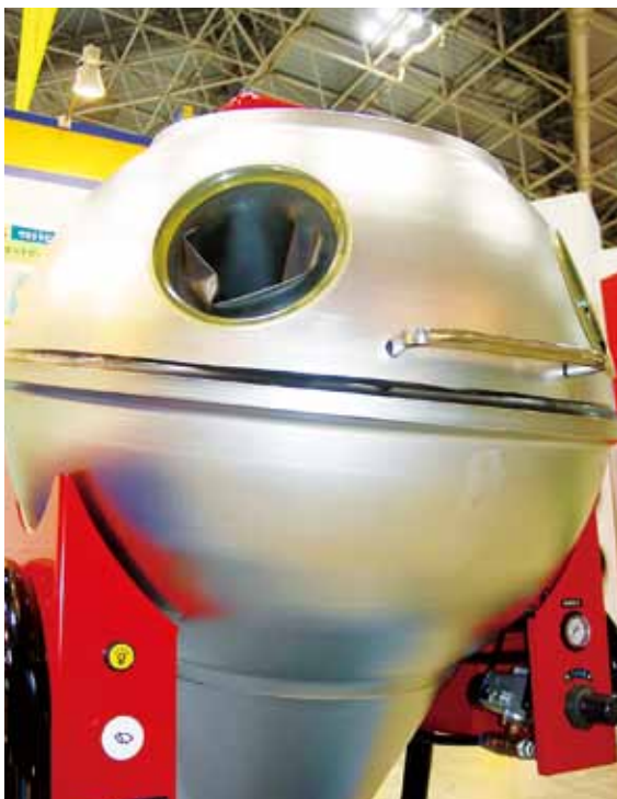
図3 ヘラ絞りによる球体ボディ
