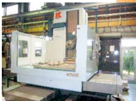
機械設備の一例 (横中ぐり盤)
