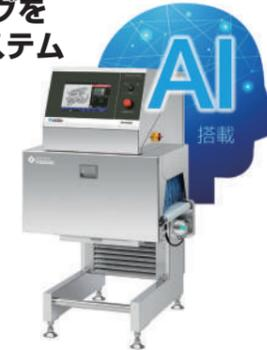
当社では、画像認識分野で高い性能を発揮し注目されているAI・ディープラーニングを搭載した異物検査システムを開発した。これまでは目視で時間をかけて判別していた魚の残骨検査を、自動判別できるシステムとして他社に先駆けて開発し、業界で初めての製品化に成功した。検査員が魚の骨の除去作業に平均20秒かかっていた時間が、AI判別されたマーキングにより4秒に短縮した。作業時間が短縮し、生産性の向上と高品質化が実現されたため、ユーザーからの満足度は高い。AIにより検査精度が高くなったことで、社会的な問題にもなっている食品ロスの低減にも貢献している。食品以外にも応用範囲は広く、医薬・化粧品・工業製品などの検査にも既に開発対応しており、これからも大きな発展が見込まれる。
