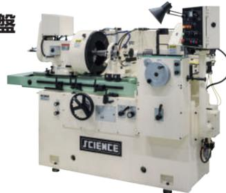
ものづくりの根本である測定において、基準測定機器の製造で培ってきた技術を研削盤へ水平展開し、現在のものづくりとは相反するハンドメイドで作成した円筒内面・端面研削盤である。摺動部においては滑り摺動を採用し、長期に亘り精度を維持する為に機械加工では対応が難しい範囲を、きざげやラップ技術を用い、作り込みを行っている。特に汎用の研削盤では切削加工機とは異なりオペレータの技術に頼る範囲が残されている。本機は要求される仕上り精度に対し、デジタル加工機では追えない研削音や火花の出方等により、各製品毎の調整を可能としている。
