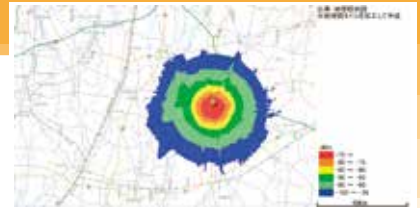
2.5GHz帯BWAの電波強度シミュレーション例 (無指向性アンテナ)
